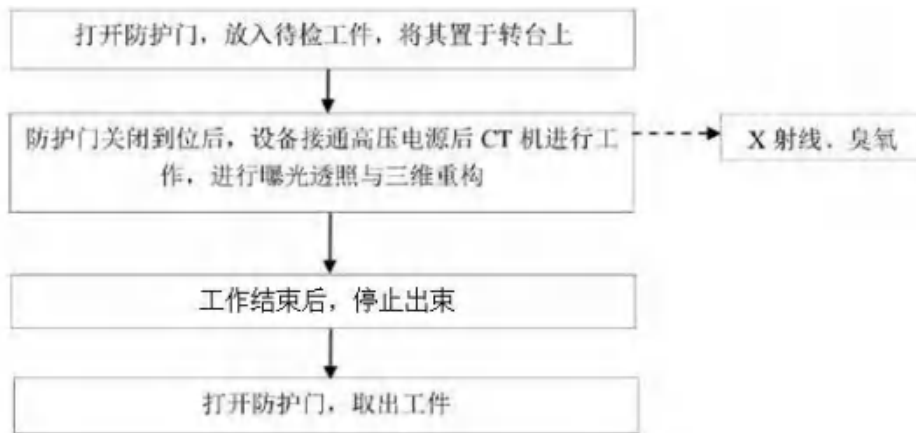
图 9-4 工业 CT 工作流程及产污环节分析示意图
