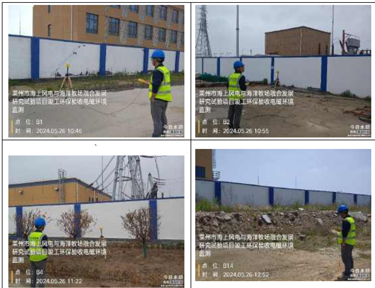
图 10.2.2.2-6 陆上集控中心电磁环境现场监测照片
