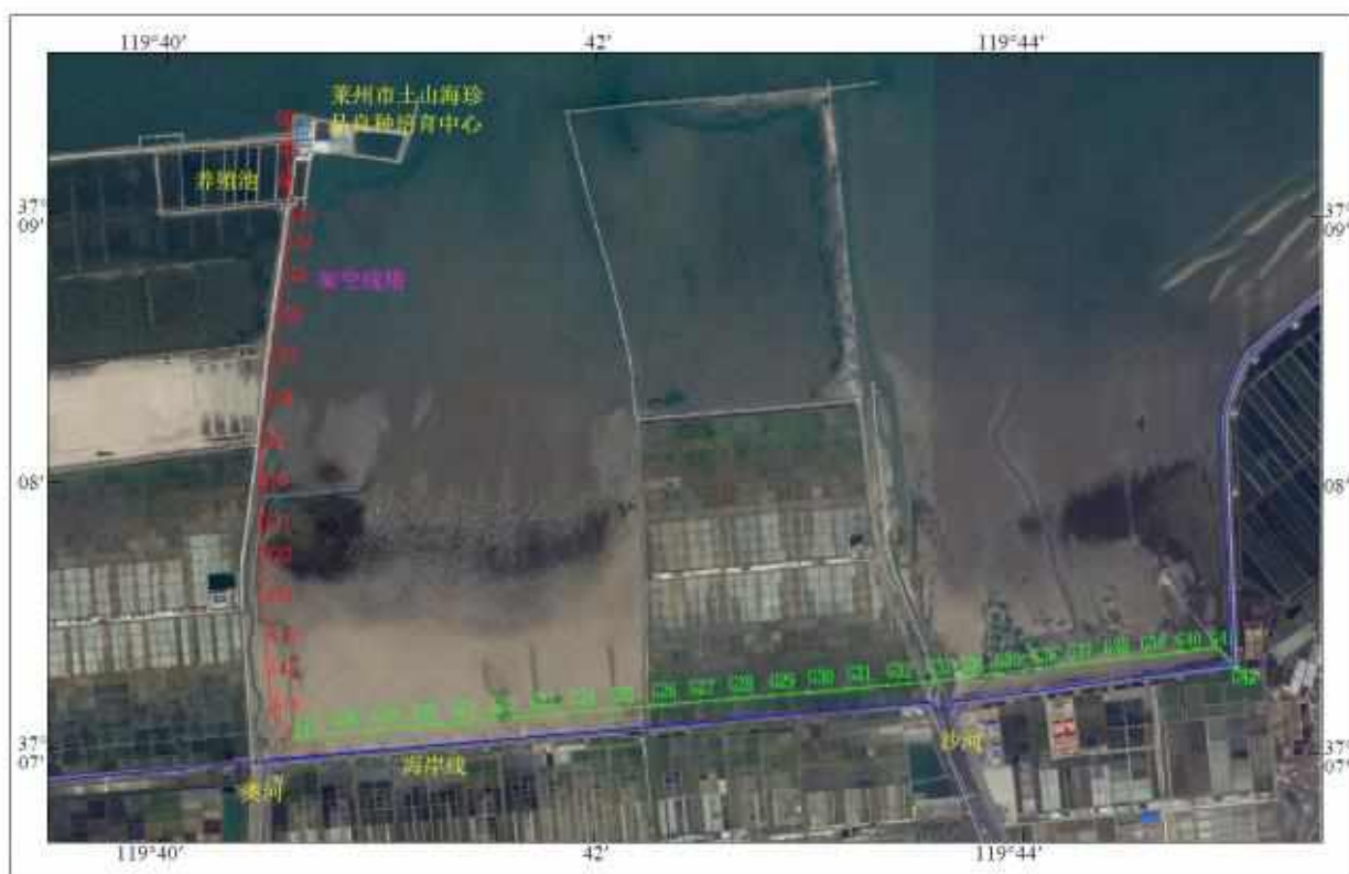
图 3.3-10 架空线塔平面布置（实际建设阶段）
