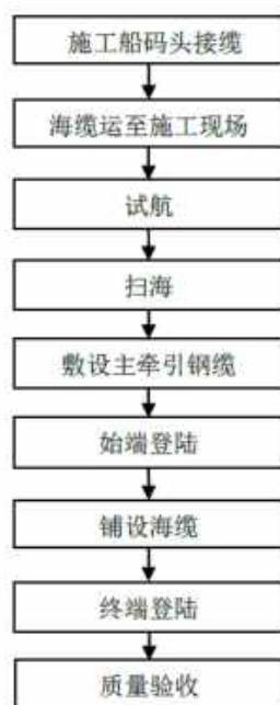
图 3.3.7-2 海缆敷设施工工艺
